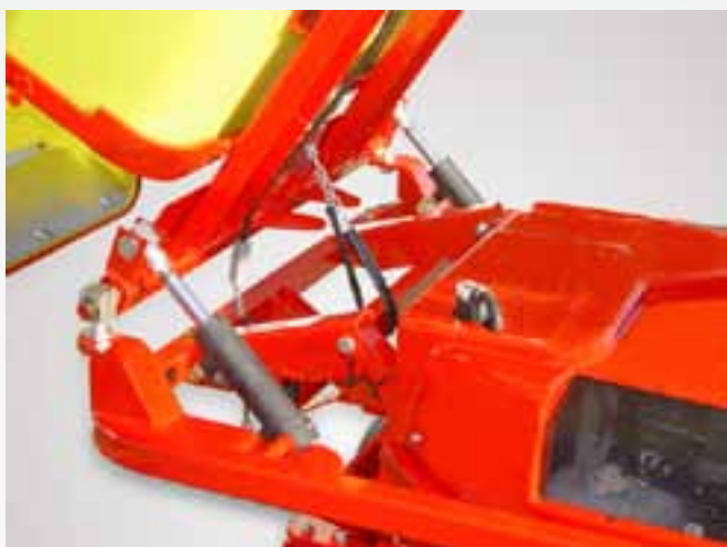
SportChamp SC2B/ D: Hydrauliczny podnośnik do opróżniania pojemnika filtra
