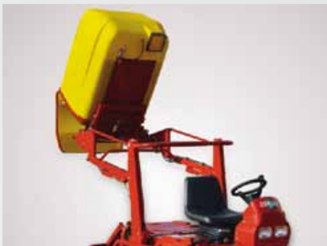
SportChamp SC2D 4HL: Hydrauliczne opróżnianie na wysokim poziomie do 2.000 mm
