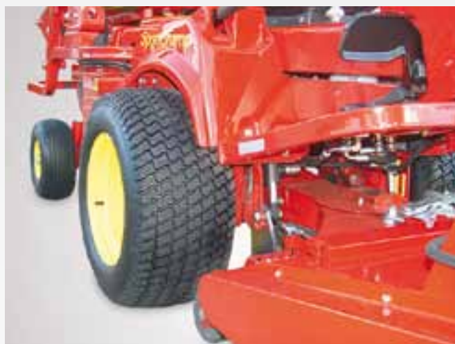
Opony do jazdy po nawierzchniach trawiastych wywierają minimalny nacisk na nawierzchnię
