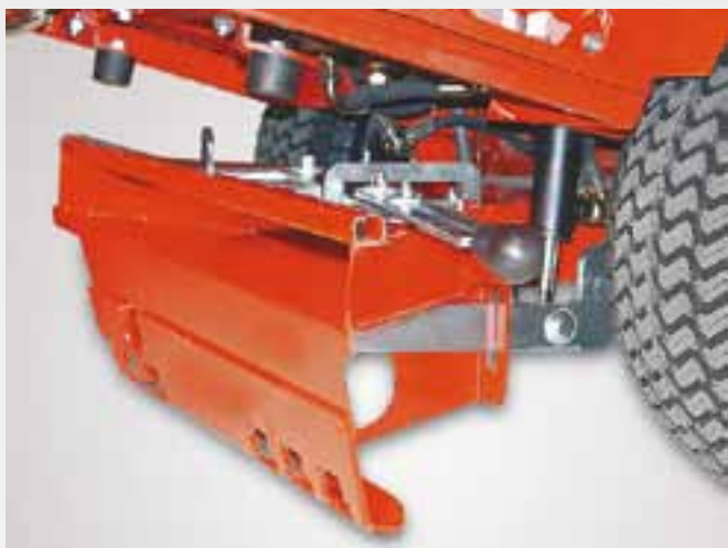
Praktyczny system sprzęgu do montażu przystawek bez konieczności użycia dodatkowych narzędzi
